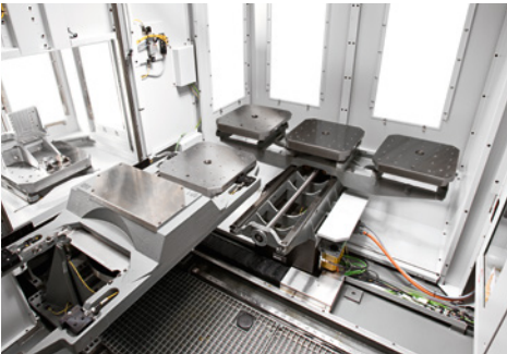
Palettenwechsler PW 850 mit Speicher
