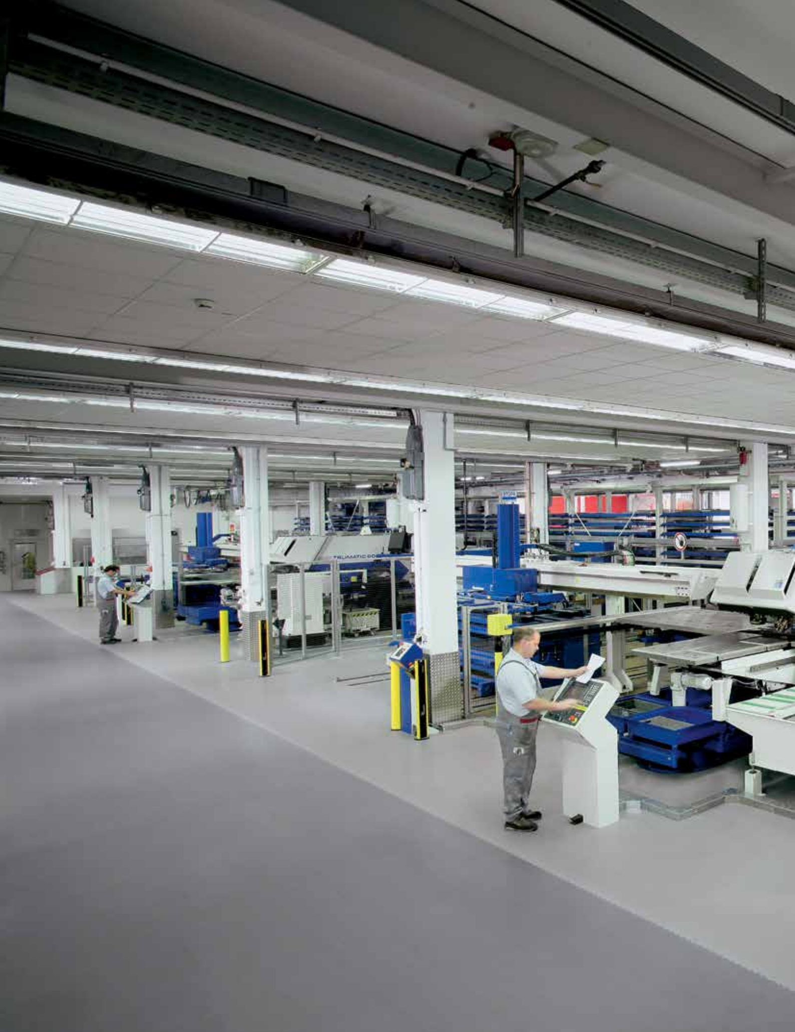
Vollautomatische Blechfertigung mit modernsten Laser-Stanzanlagen.
