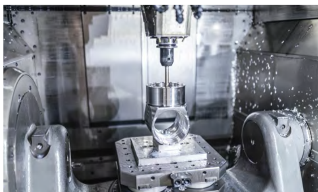
Fertigung eines komplexen Bauteils für die Luftfahrtindustrie auf der C 22 U.
