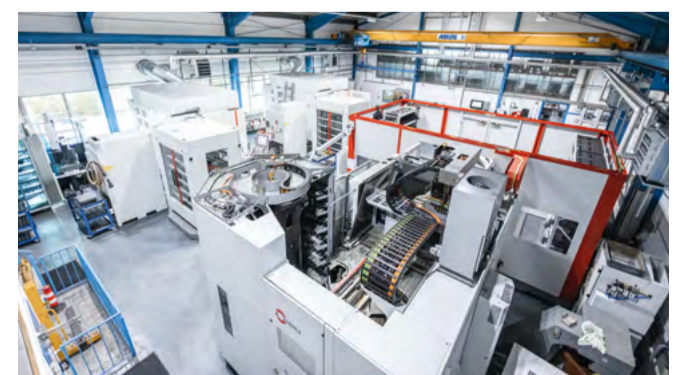
Auf den beiden C 22 U (im Hintergrund) bearbeitet TVB ausschließlich Grafit. Der Roboter belädt die C 32 U (vorn rechts) mit Aluminium- und Messingbauteilen.
