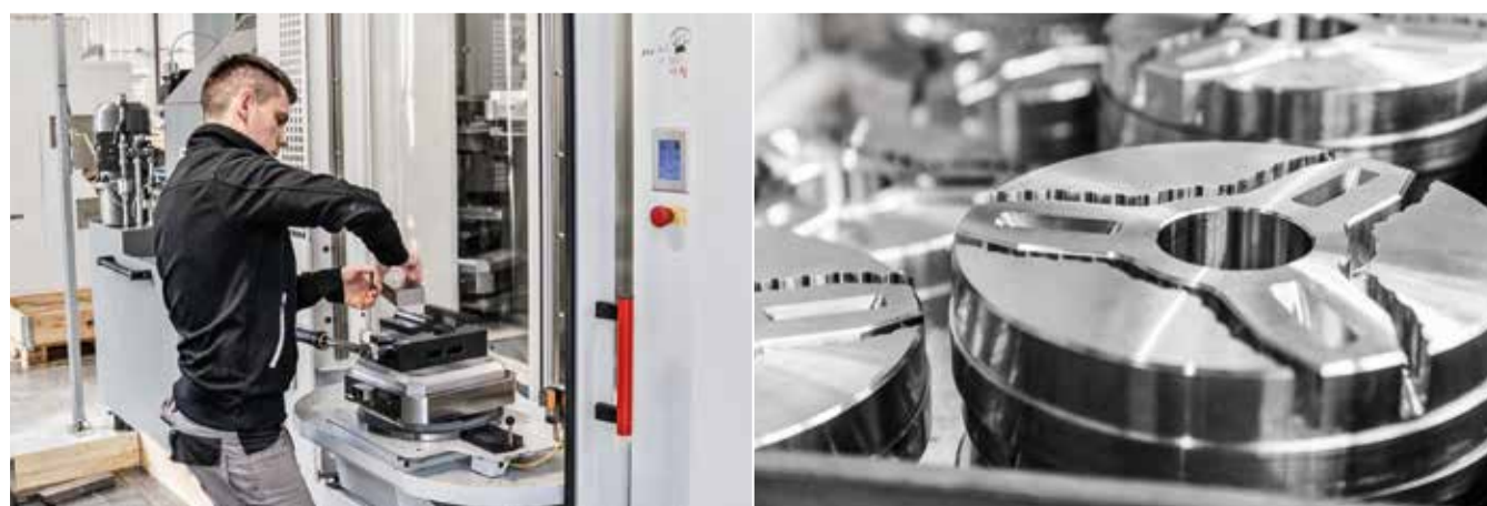
links: Die C 22 UP verfügt über ein Palettenwechselsystem, das dem Bediener das hauptzeitparallele Rüsten ermöglicht. rechts: Fertigung komplexer Produkte bedeutet höchste Präzision bei schwer zerspanbaren Materialien.
