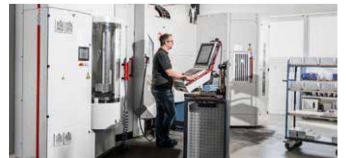
oben Das Hermle-Fertigungszentrum bei HZT Honermeier bestehend aus dem 5-Achs-Bearbeitungszentrum C 400 U und der Automationslösung HS flex.
