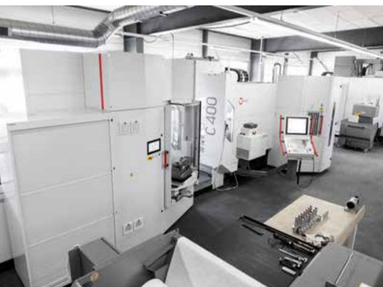
Das Bild zeigt einen Teil des „Hermle-Boulevard“ im Hause Feusi AG mit dem 5-Achsen Bearbeitungszentrum C 400 U mit Werkstückmagazin, dem 5-Achsen Bearbeitungszentrum C 22 U mit Palettenwechsler PW 150, und dem 5-Achsen Bearbeitungszentrum C 42 U/MT mit Drehfunktion
