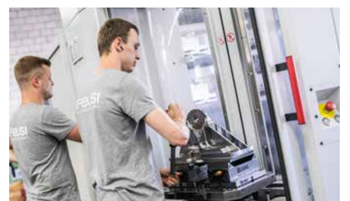
zeigt den bedienfreundlich angeordneten Rüstplatz des Palettenwechslers PW 150
