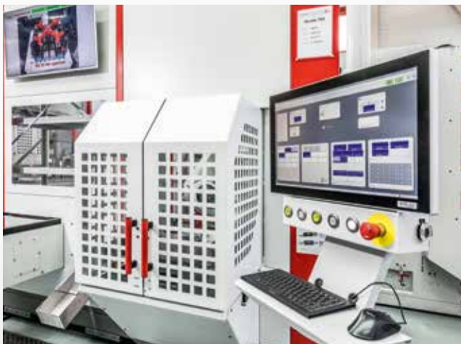
Robotersystem RS 2 Kombi mit Kanban, adaptiert an ein 5-Achsen Bearbeitungszentrum C 32 U dynamic
