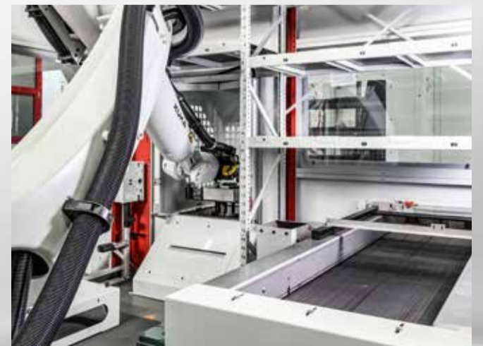
Palettenspeicher, Rüstplatz (hinten) und Transportband für Werkstücke
