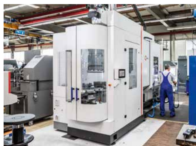
zeigt den Palettenwechsler PW 150 zum Bearbeitungszentrum C 22 UP; im Vordergrund ist der (drehbare) Rüstplatz zur Beschickung der Paletten/Werkstückaufnahmen mit Werkstücken bzw. zur Entnahme der Fertigteile zu sehen
