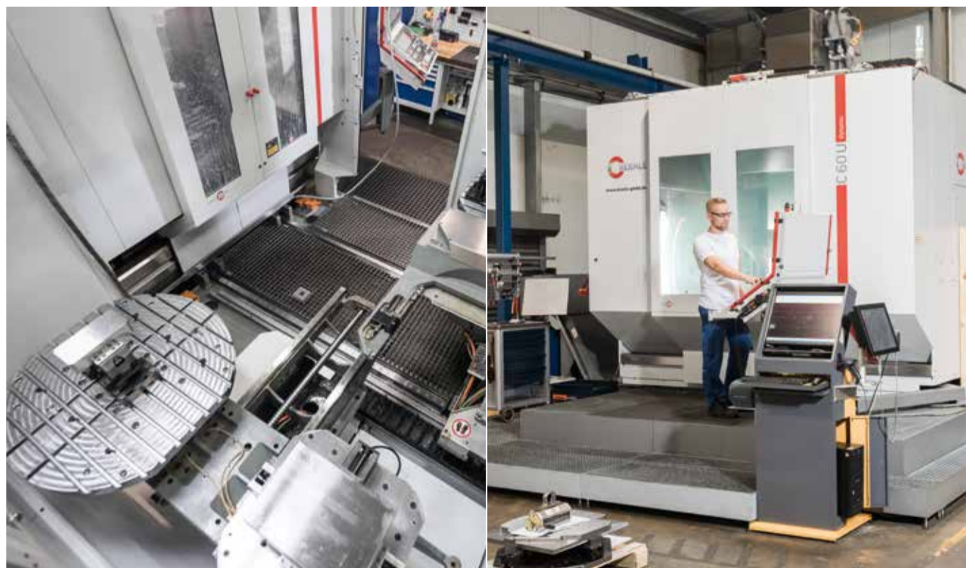
links Das Palettenwechselsystem des hochflexibel einsetzbaren 5-Achsen-CNC-Hochleistungs-Bearbeitungszentrums C 42 UP für die „Rund-um-die-Uhr“-Komplettfertigung von Formplatten, Formaufbauten und Aktivteilen aus dem Werkzeug- und Maschinenbau rechts das 5-Achsen-CNC-Hochleistungs-Bearbeitungszentrum C 60 U für Großteile.
