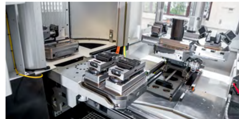
Palettenwechsler PW 250 mit dem Palettenspeicher (rechts hinten) und dem Rüstplatz (links); inklusive der im Arbeitsraum befindlichen Paletten sind sieben Paletten im System, die mit gleichen oder unterschiedlichen oder Mehrfach-Spannaufnahmen bzw. Werkstücken zu beladen sind
