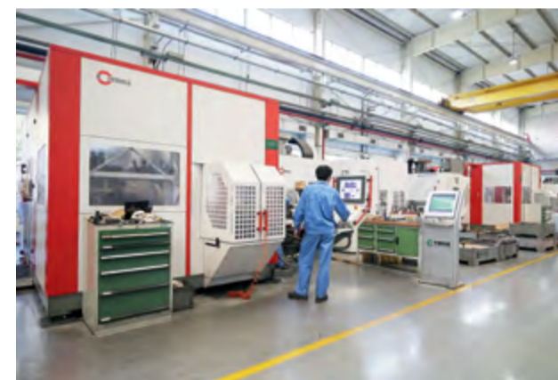
Oben: Die beiden 5-Achsen-CNC-Hochleistungs-Bearbeitungszentren C 40 U mit RS 2 für die hochautomatisierte Fertigung von Bauteilen für Zigaretten-Verpackungsmaschinen Bild links: Hr. Hu, Serviceleiter Hermle China und Hr. Zhu, Projektleiter Shanghai Tobacco
