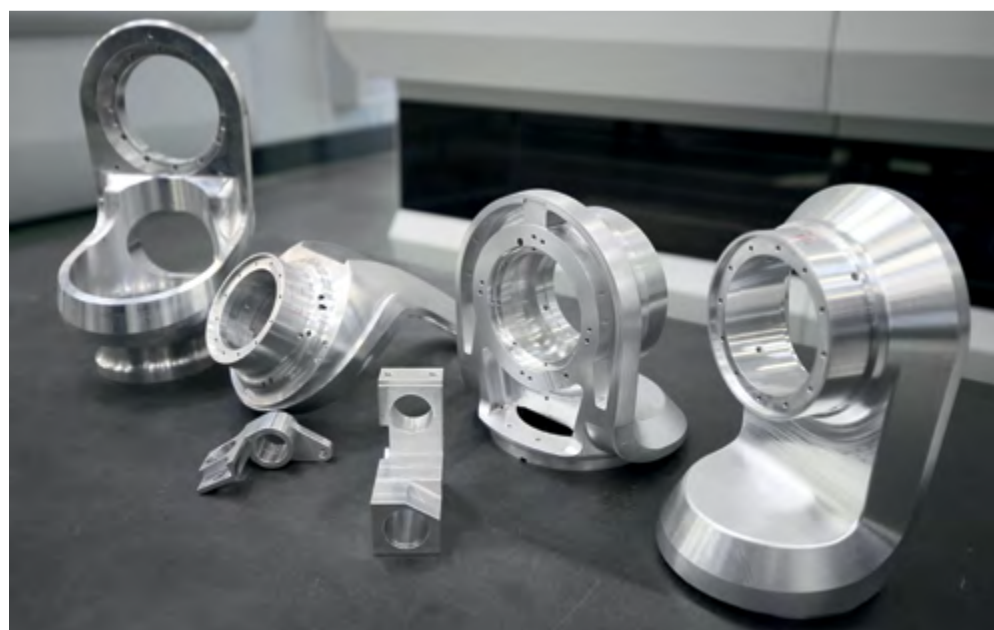
Roboter-Bauteile in verschiedenen Größen, die auf den zwölf neuen Hermle-Bearbeitungszentren C 42 UP komplett gefertigt werden
