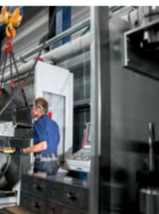
Zeigt den per Kran sehr einfachen Beladevorgang eines Bearbeitungszentrums C 60 U bei geöffneter Doppeltüre
