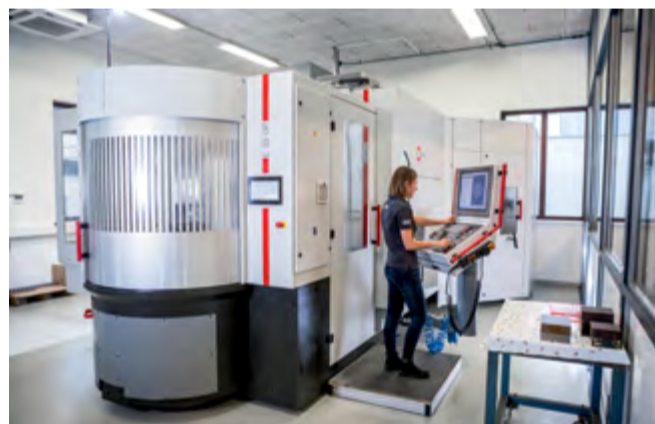
Gesamtansicht des Hermle CNC-5-Achsen-Hochleistungs-Bearbeitungszentrums C 32 U mit Palettenwechsler und Palettenspeicher PW 250; frontseitig befindet sich der Rüstplatz des PW 250
