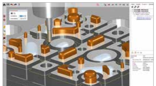
MPA Studio berechnet und simuliert Auftrags- wie auch Zerspanungspfade für den MPA-Prozess.
