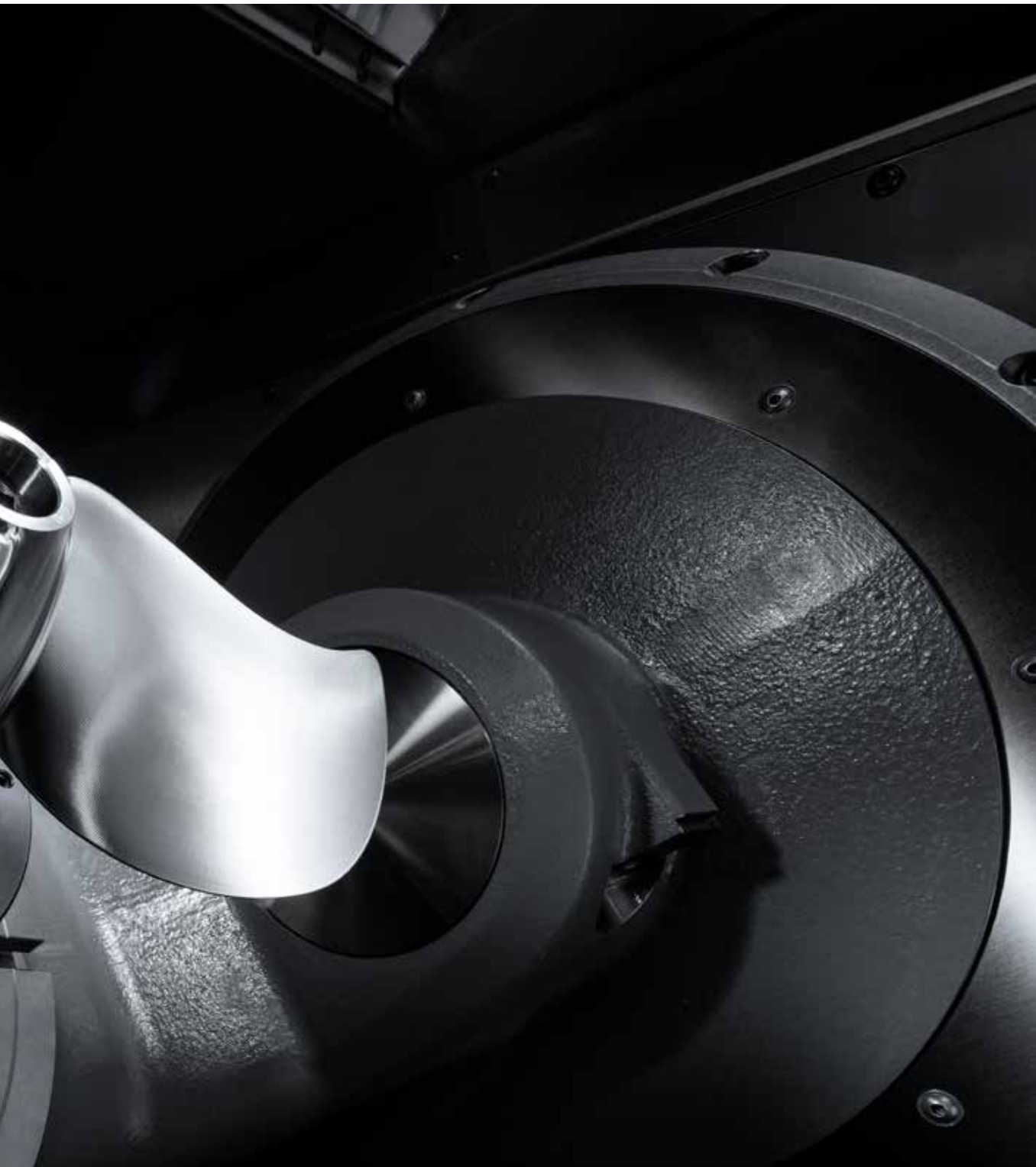
HERMLE C 42 U dynamic in 5-Achs-Ausführung | Bearbeitung eines Propellers für die Sport- und Freizeitindustrie.
