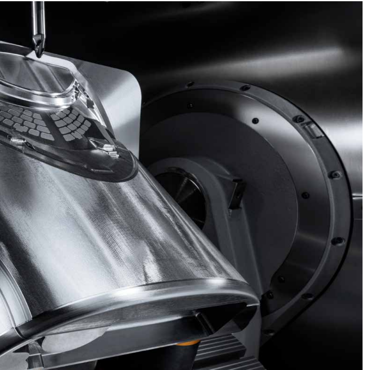
HERMLE C 42 U dynamic in 5-Achs-Ausführung | Bearbeitung eines Gesenkes für den Werkzeug- und Formenbau.
