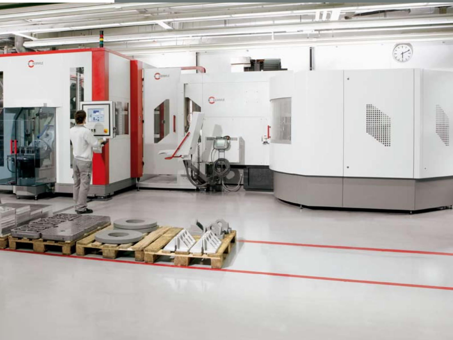
Robotersystem RS 3 in der Spanenden Fertigung
