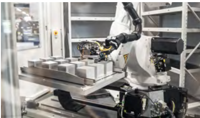
oben Die Universalmatrize passt sich unterschiedlichen Geometrien flexibel an.
