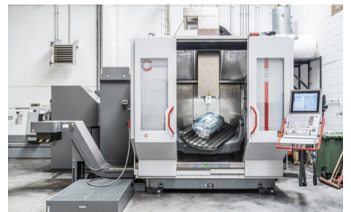
Mit ihrem Arbeitsbereich von 1.000 x 1.100 x 750 Millimetern und einer Maulweite von 950 Millimetern hat die C 52 U selbst für die größten Formwerkzeuge Platz.
