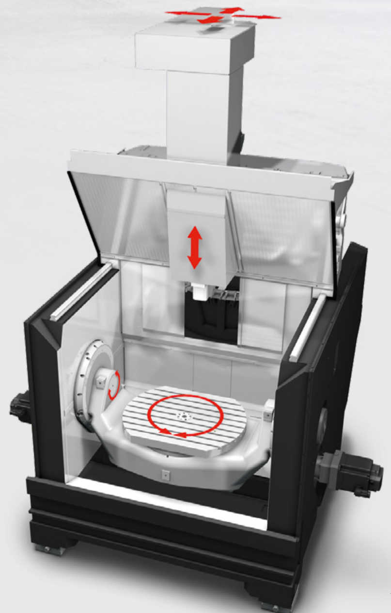
Leistungsstark fräsen mit der 5-Achs-Technologie: Drei Achsen im Werkzeug, zwei Achsen im Werkstück.
