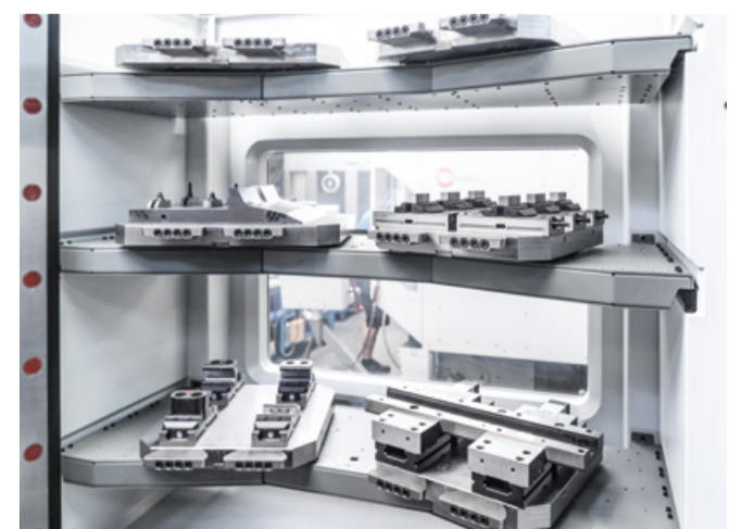
Cafmeyer nutzt die C 650 U auch für kleinere Bauteile – und packt diese für eine effiziente Bearbeitung auf eine Palette zusammen.
