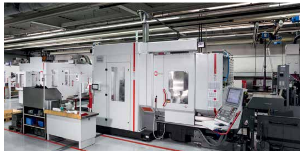
Hermle C 12 U mit Palettenwechsler PW 150 – unsere Ausbildungsmaschine in der Spanenden Fertigung
