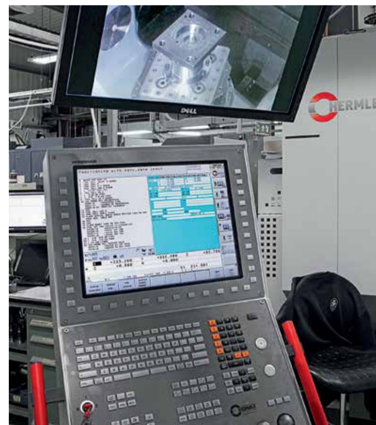
Der über der Heidenhain-Maschinensteuerung angeordnete Monitor zur Überwachung des Bearbeitungsraums
