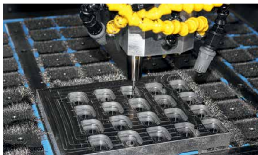
Eine Wechselpalette mit aufmontierter Magnetspannplatte und dem 20-fach Werkzeugeinsatz eines Spritzgießwerkzeugsystems bei der Finishbearbeitung.
