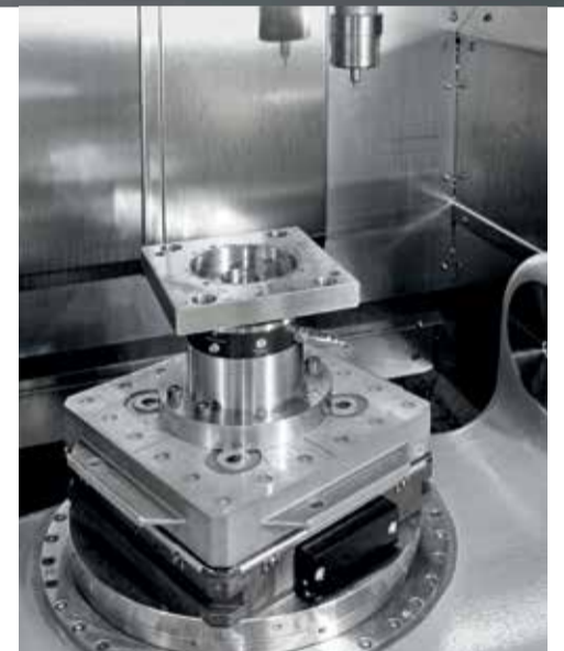
5-Achs-Schwenkrundtischanordnung der C 22 U
