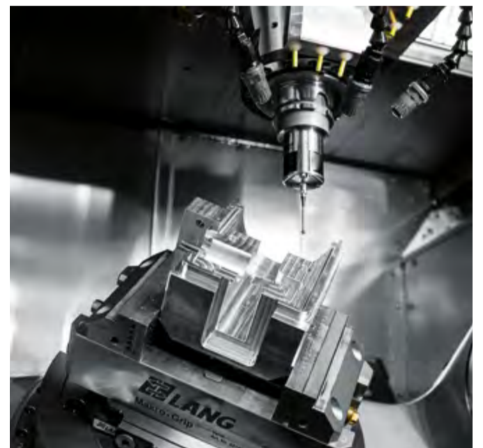
Bild zeigt den Arbeitsbereich des 5-Achsen-CNC-Hochleistungsbearbeitungszentrums C 32 U mit dem NC-Schwenkrundtisch für die 5-Achsen-/5-Seiten-Komplett-/Simultan-Bearbeitung in einer Aufspannung
