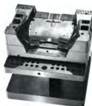
Bild zeigt einen Formeinsatz aus 1.2767/56HRC, bei dem nach dem 5-Achs-Simultanfräsen mit sehr kleinen Fräsern (D0,6) nur noch wenige Elektroden zum Erodieren notwendig waren
