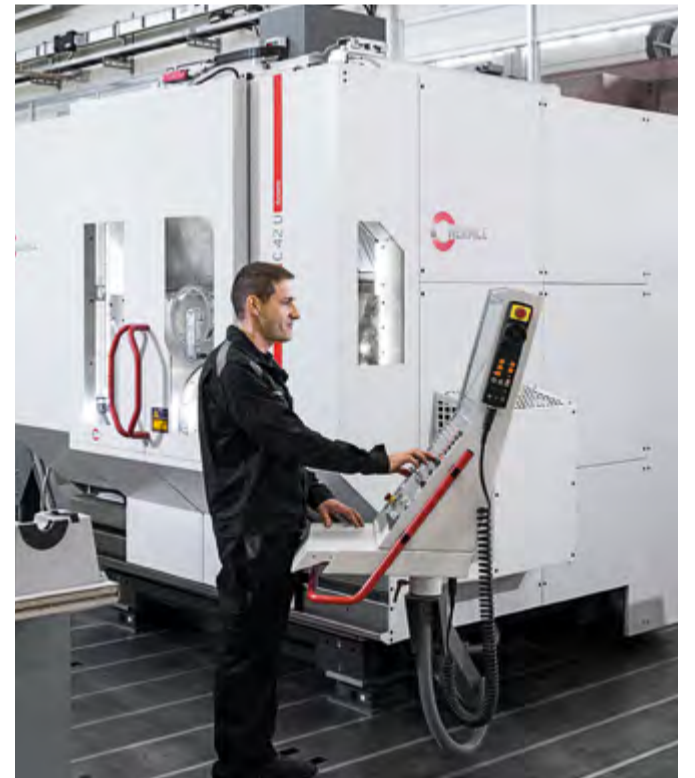
Das beim CERN-Department MME installierte 5-Achsen-CNC-Hochleistungs-Bearbeitungszentrum C 42 U dynamic, ausgerüstet mit den Genauigkeitspaketen I und II für die hochpräzise, reproduzierbar genaue Qualitätsbearbeitung im Bereich von +/-0,5 µm
