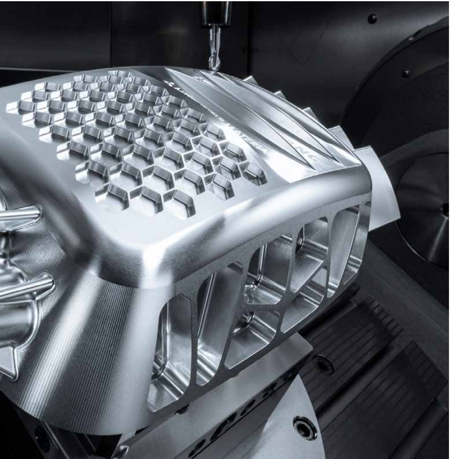
HERMLE C 42 in 5-Achs-Ausführung | Bearbeitung eines Technologiebauteils für die Luft- und Raumfahrttechnik.
