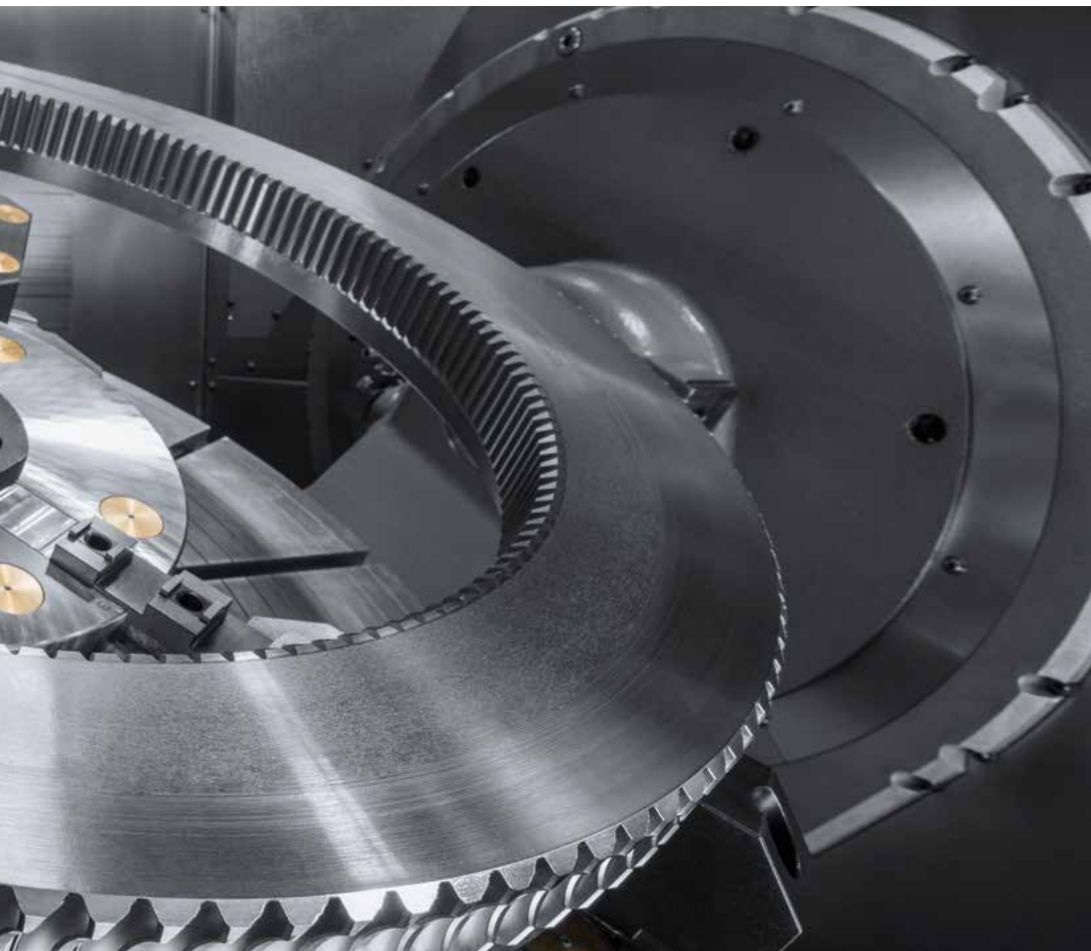
Maschinenbau. Zahnrad mit einer Schneckenrad-Außenverzahnung und einer mittels Wälzschalen hergestellten geraden Innenverzahnung.
