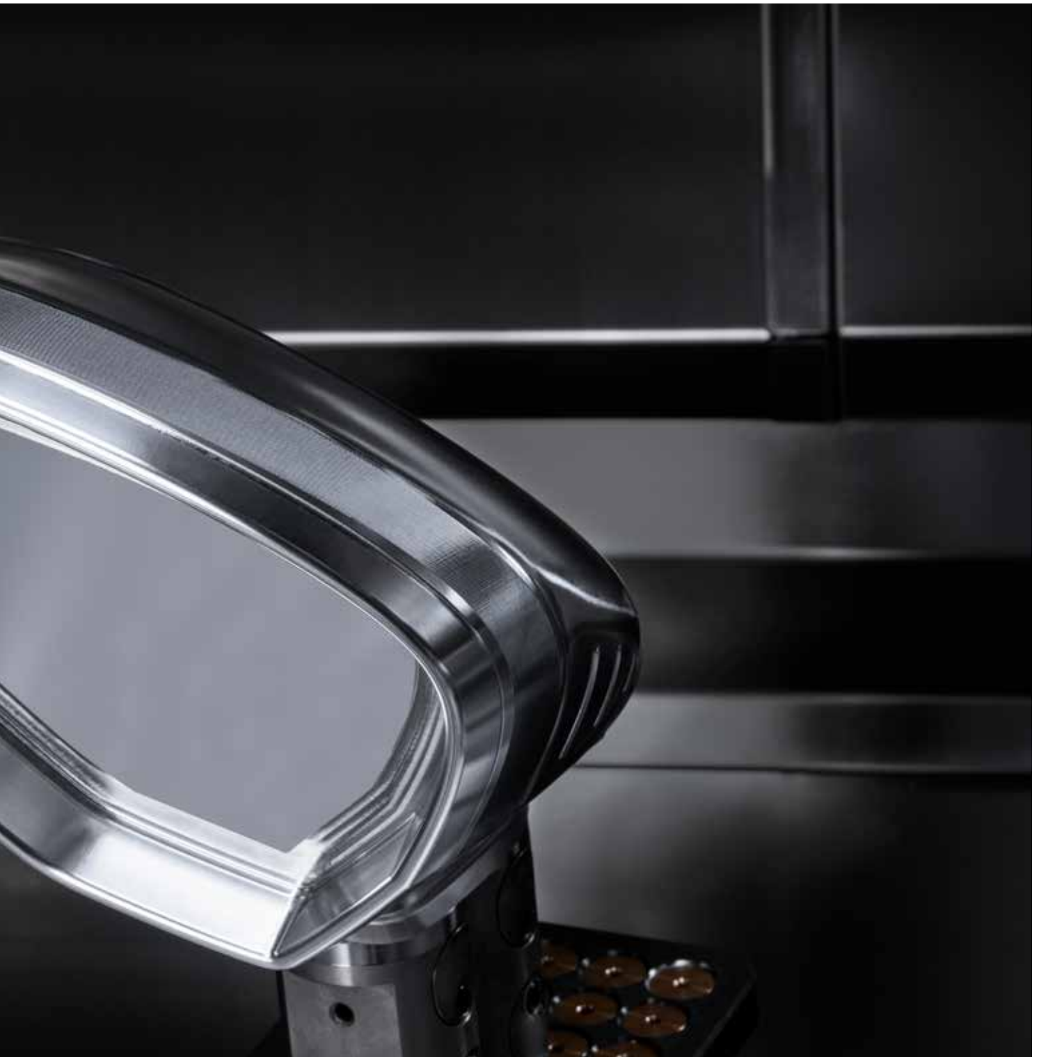
Hermle C 42 U dynamic in 5-Achs-Ausführung | Bearbeitung eines PKW-Spiegels für den Modellbau.
