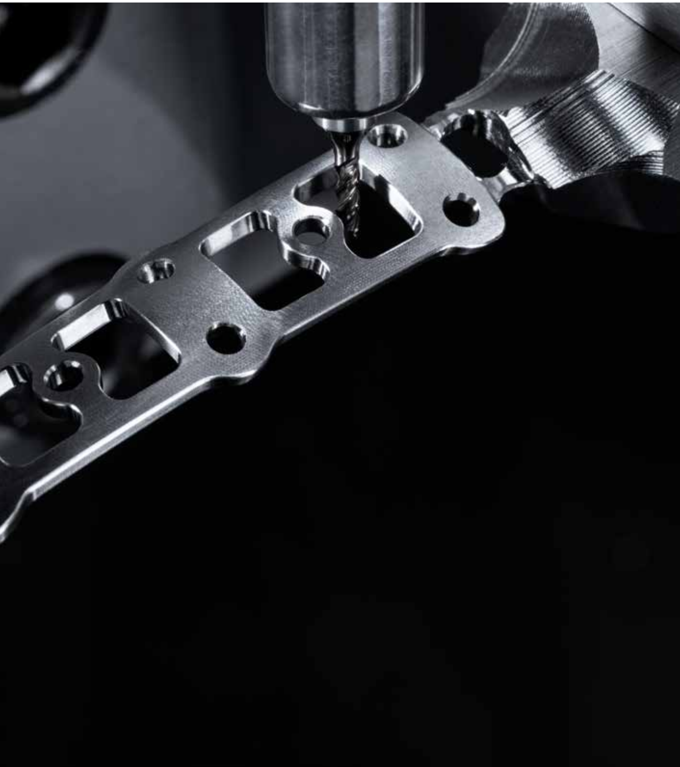
Hermle C 22 U dynamic in 5-Achs-Ausführung | Bearbeitung einer Knochenplatte für die Medizintechnik.
