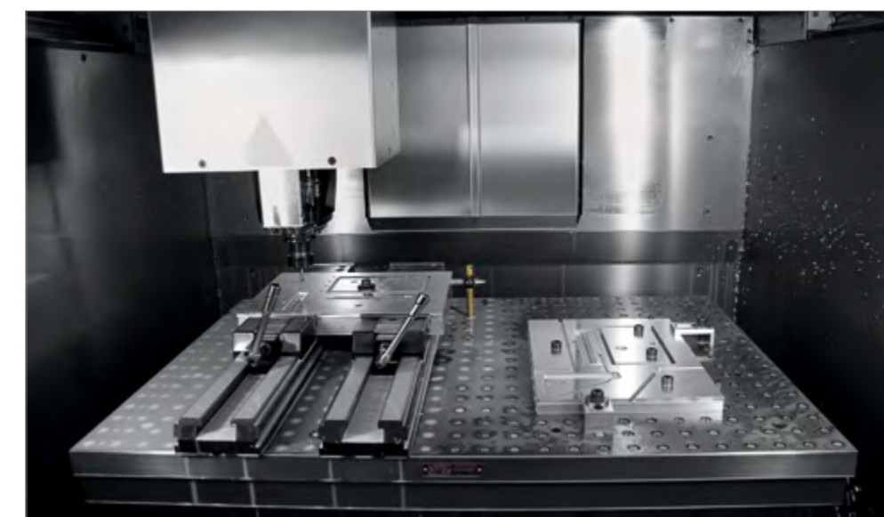
Großer Arbeitsbereich des BAZ C 40 V mit X-Y-Z = 850-700-500 mm und dem starren Aufspanntisch mit 1.070 x 700 mm Aufspannrille; der Tisch ist universell zu nutzen mit Standard- und Sonder-Spannvorrichtungen; die schlanke Bauweise der Z-Achse bzw. Frässpindel bringt eine sehr gute Zugänglichkeit zur 5-seitigen Flächen-Bearbeitung.
