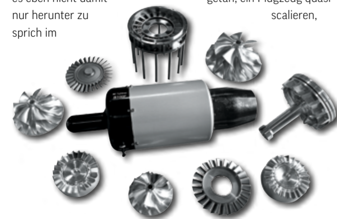
Eine Auswahl anspruchsvoller, 5-achsig zu bearbeitender Turbinen-Bauteile aus hochfestem Aluminium, Inconel-Halbzeug und Inconel-Feinguss.
