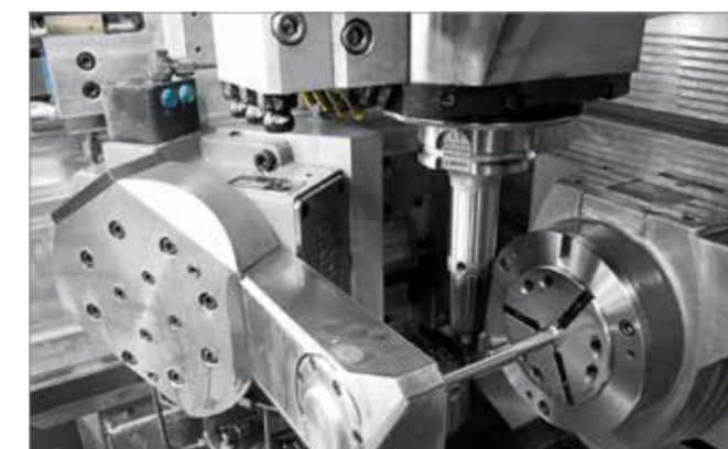
Bearbeitung eines lang auskragenden Sonderwerkzeughalters auf dem Hermle BAZ C 40 U mit Gegenhalter, der Gegenhalter sitzt auf einem Schlitzen und erlaubt die Bearbeitung von bis zu 250 mm langen sowie wellenförmigen Teilen.
