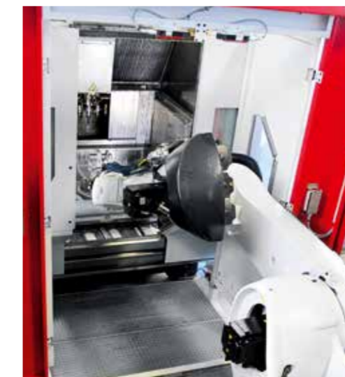
Links: Roboter beim Handling einer Werkstückpalette; der Roboter entnimmt aus dem Palettenregal eine Palette und setzt sie auf dem vorgegebenen Maschinentisch ab; zuvor holt er die Palette mit dem Fertigteil heraus und setzt diese im Magazin ab; außerdem bestückt ist der Roboter für das Paletten-Handling ab und auf den Rüstplatz zuständig.
