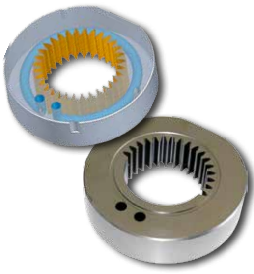
Spritzgusswerkzeug aus 1.2344 (härtpfester Warmarbeitsstahl, H13).
