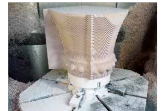
Arbeitsraum des Hermle-BAZ C 30 U mit NC-Schwenkrundtisch (Ø 630 mm) für die 5-Achs-Komplettbearbeitung anspruchsvoller Prototypen, Modelle und Werkzeug-Segmente in 3D-Umgebung.
