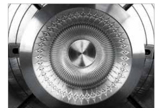
Filigran gefrästes Formwerkzeug einer Schale mit feinen Details.
