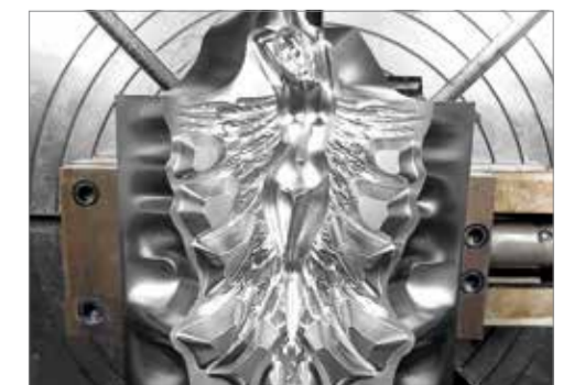
Weiteres Formwerkzeug aus Formenbau-Spezialguss zum Gießen einer exklusiven Kristallglas-Skulptur.
