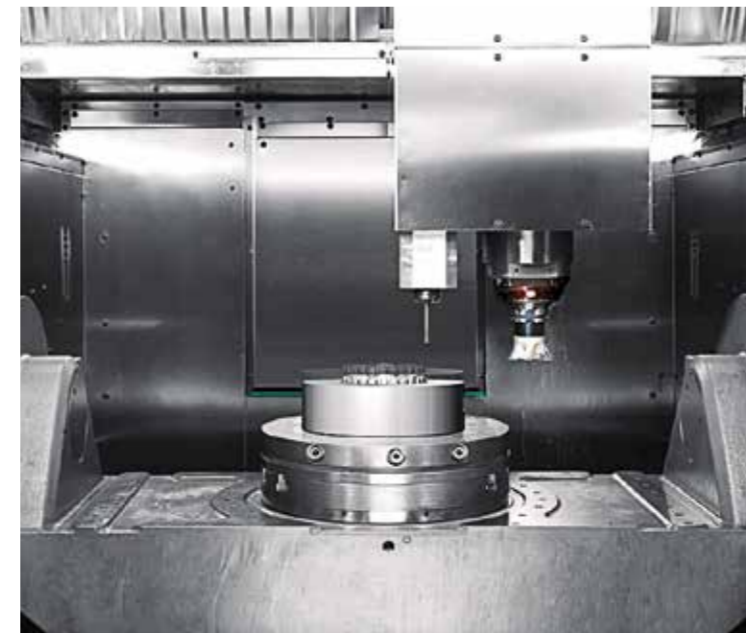
Arbeitsraum des 5-Achsen-Bearbeitungszentrums mit integrierter MPA-Technologie bei der Herstellung eines Werkzeugzeugsatzes.
