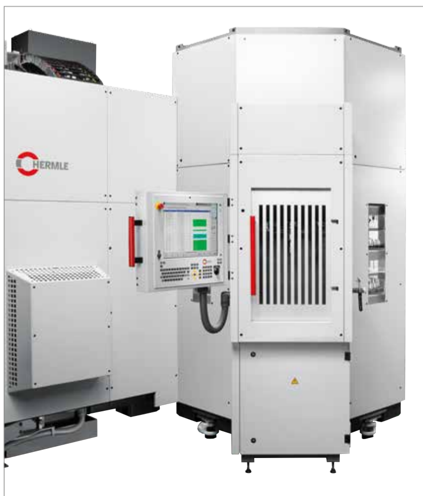
Ausführung für die C 50/MT und C 60/MT mit zusätzlichem Bedienfeld
