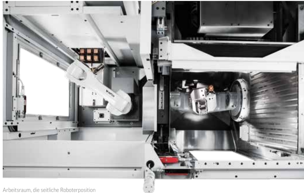
Arbeitsraum, die seitliche Roboterposition mit Matrize beim Wechselvorgang (von oben)
