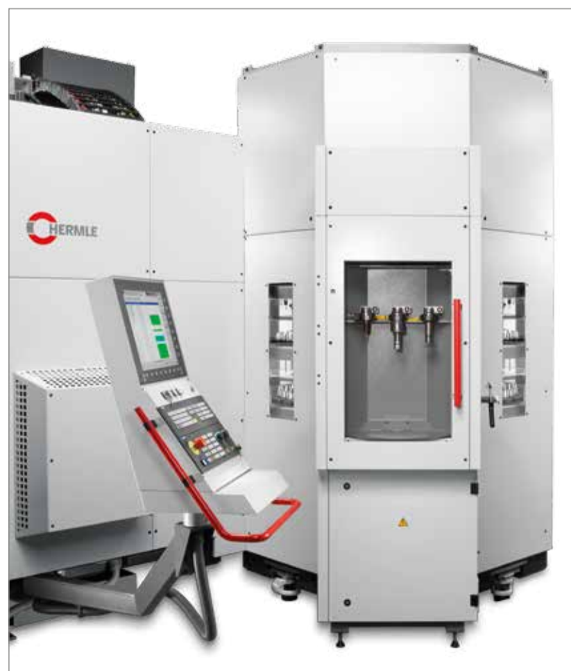
Ausführung für die C 32 und C 42/MT. Maschinenbedienpult kann zur Be- und Entladestelle geschwenkt werden
